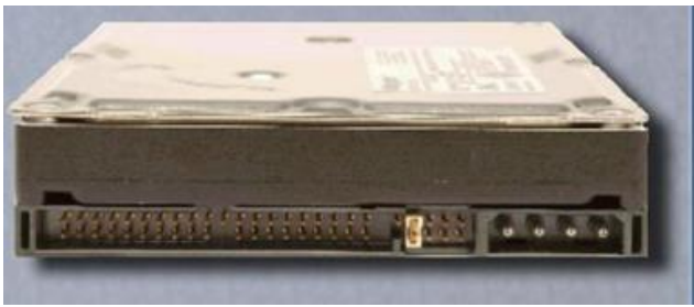
Рис. 12. Розташування перемичок на задній стороні жорсткого диска PATA
